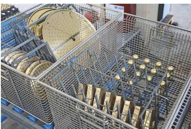
Standardkörbe mit speziellen Einsätzen: Das Reinigungsmedium kann alle Werkstücke umspülen. Bild: Pero
