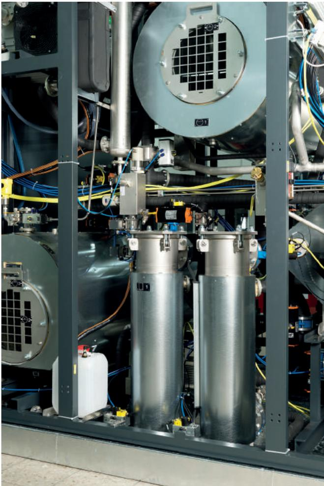
**Bild 3:** Eine hohe Leistung der Destillation (links) sichert ein optimal gepflegtes Medium im Tank (oben) und prozesssichere Reinigungsergebnisse. Die Filter (vorne) sind entweder dem Reinigen oder dem Spülen zugeordnet und können vor dem Wechseln automatisch getrocknet werden
