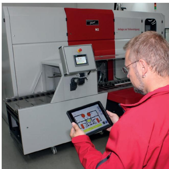
Bild 1 a/b: Mit Drehteilen werden häufig eine hohe Spänefracht und viel Öl bzw. Emulsion in die Reinigungsanlage eingetragen – die Schichtautomatik erledigt viele Wartungen mannos und komfortabel
