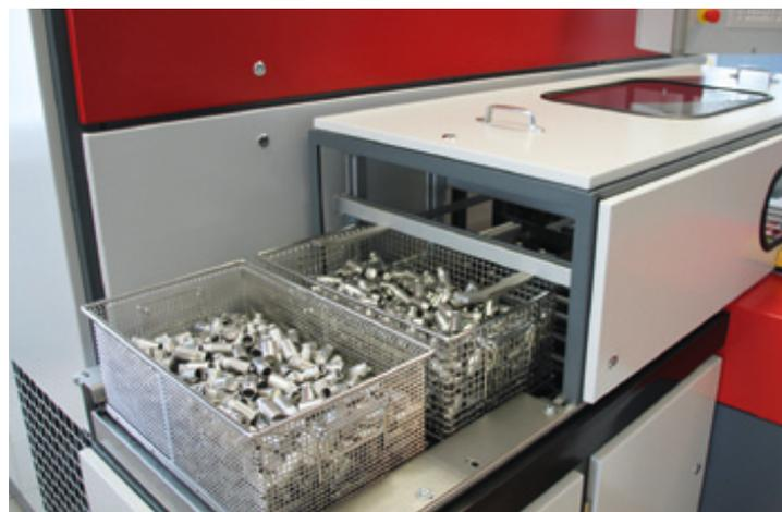
**Wird durch schöpfende Setzware (Bild links) oder Tiefziehteile (Bild rechts) viel Schmutz in die Anlage eingetragen, so erledigt die Schichtautomatik viele Wartungen komfortabel.**
