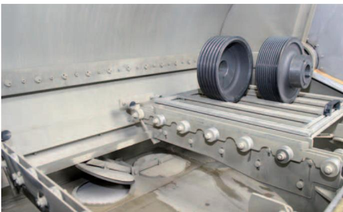
Der Pero-Robomat erreicht mit dem schwenkbaren Sprüharm alle relevanten Bereiche – auch bei schwierigen Geometrien.
