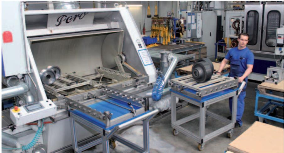
Kürzere Durchlaufzeiten: Der Robomat ist einfach bedien- und beschickbar, deshalb können die Facharbeiter für Zerspanungstechnik die Reinigungsaufgaben der Treibscheiben selbst erledigen.
