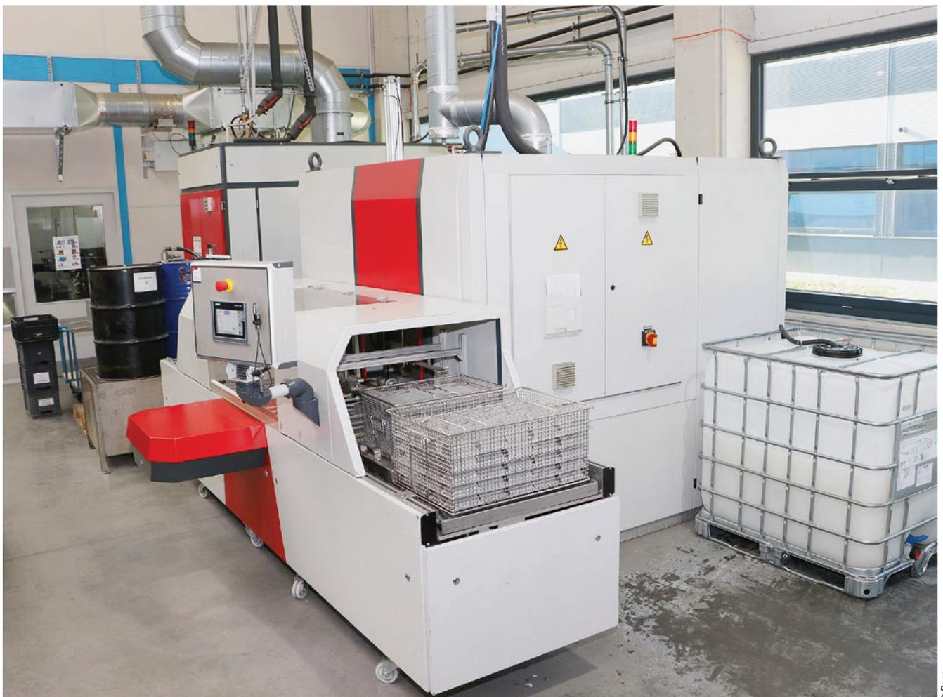
Die wasserbasierte Reinigungsanlage sorgt bei Dynacast in erster Linie für eine schnelle, saubere und fleckenfreie Zwischenreinigung von Bauteilen.
