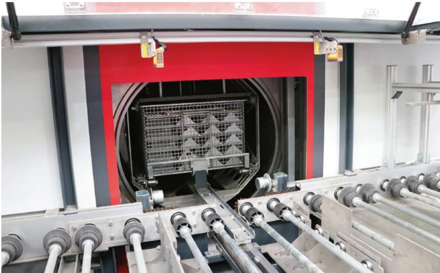
Der Reinigungsvorgang läuft vollautomatisch. Dank individuell anpassbarem Düsensystem und einem großen Spritzvolumen von bis zu 700 Liter pro Minute werden auch komplexe Bauteilformen zuverlässig von Spänen und Kühlschmiermittel befreit.
