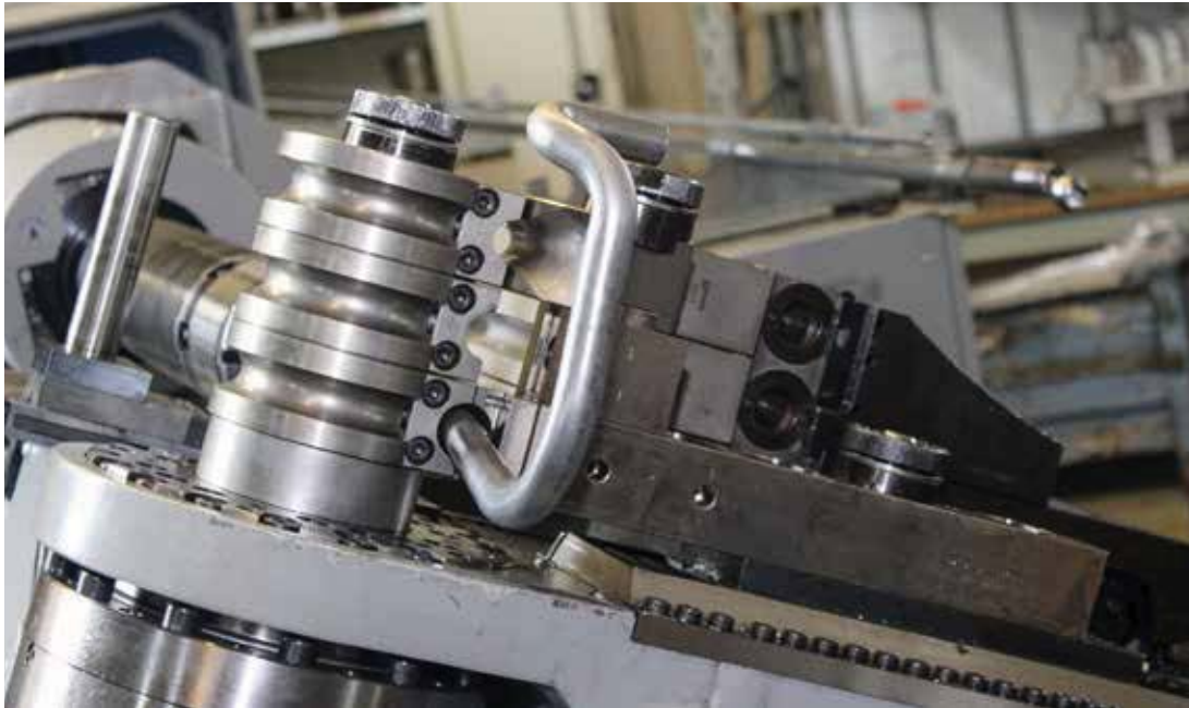
Mit viel Know-how und moderner Technik biegt Dirisamer dreidimensionale Rohreinheiten , die vor allem in mobilen Hydrauliksystemen der Agrartechnik und in Baumaschinen zum Einsatz kommen.
