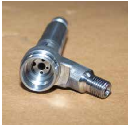
3 Der mit Bearbeitungsöl und Metallpartikeln behaftete Injektorkörper vor (links) und nach dem Durchlauf der Reinigungsanlage (© Hanser)
