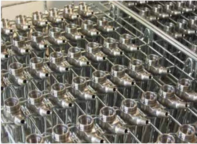
2 Die Chargen von 4 × 48 Stück werden in den werkseigenen Trägerkörben transportiert, die so auch den Reinigungsprozess durchlaufen
