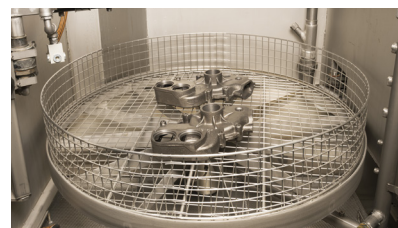
Dreh-Waschkorb mit Spritz- und Abblas-Düsen
