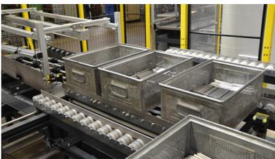
Warenträger-Einlauf aus der Fertigung, einspurig
