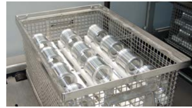
Beispiel für Reinigung mit definierter Anforderung an die technische Sauberkeit
