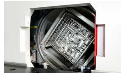
Gezielter Reinigungseffekt durch Schwenken und Rotieren des Warenträgers
