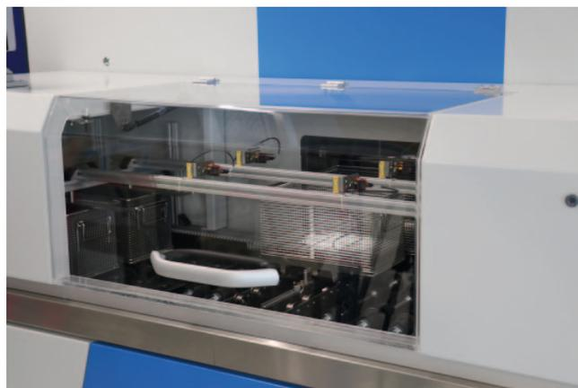
*Vollautomatisch erfolgt die Zu- und Ausführung der Bauteile in den Arbeitsraum der unter Vollvakuum arbeitenden lösemittelbasierten Reinigungsanlage Pero R1.*
