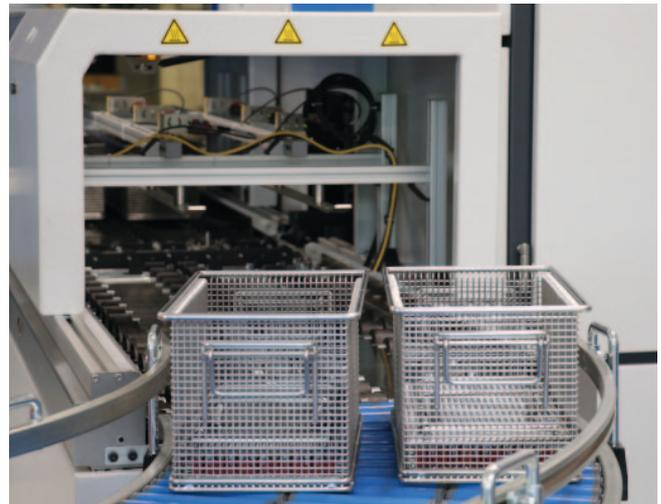
Wenn Bauteile von Mattig die Pero R1 verlassen, erfüllen sie eine hohe Technische Sauberkeit. Dies wird durch die Prozesskombinationen aus Reinigen, Spülen, Dampffetten und optionaler Ultraschallreinigung erreicht. Von Vorteil ist zudem die Möglichkeit in einem Arbeitsgang zu konservieren.
