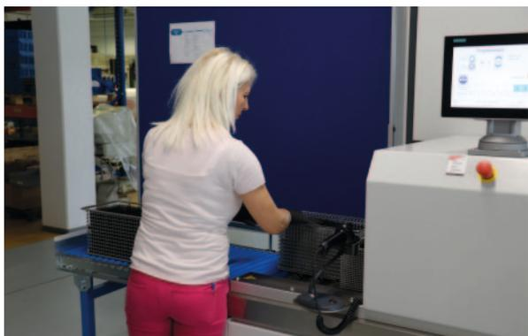
*Nach dem Einlesen eines Barcodes zur Programmzuordnung, stellt die Produktionsmitarbeiterin Stanojka Tadic von Mattig ihre Bauteilkörbe zweireihig auf die Zuführung und startet den Reinigungsvorgang in der Pero R1 am Touch Panel.*
