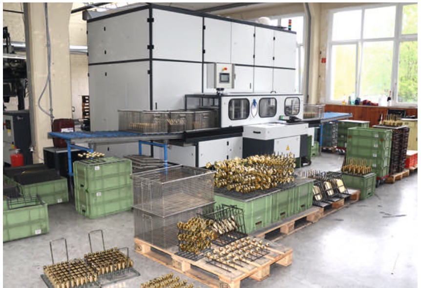
1 Flexibilität hoch drei: Die Universal-Reinigungsanlage R2 von Pero arbeitet hier mit halogeniertem Kohlenwasserstoff und ist für unterschiedliche Werkstoffe geeignet
