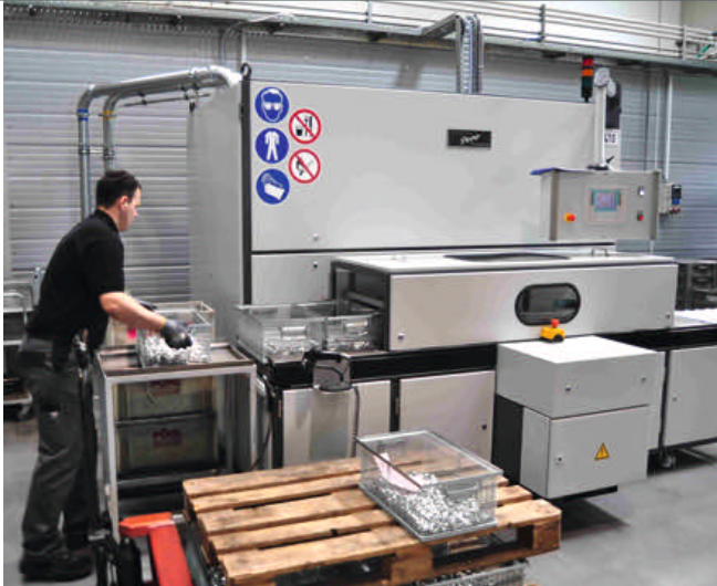
6 Die Reinigungsanlage Pero R1 kann mit dem für die Anwendung optimalen Lösemittel reinigen; hier Zink-Druckguss-Teile mit modifiziertem Alkohol
